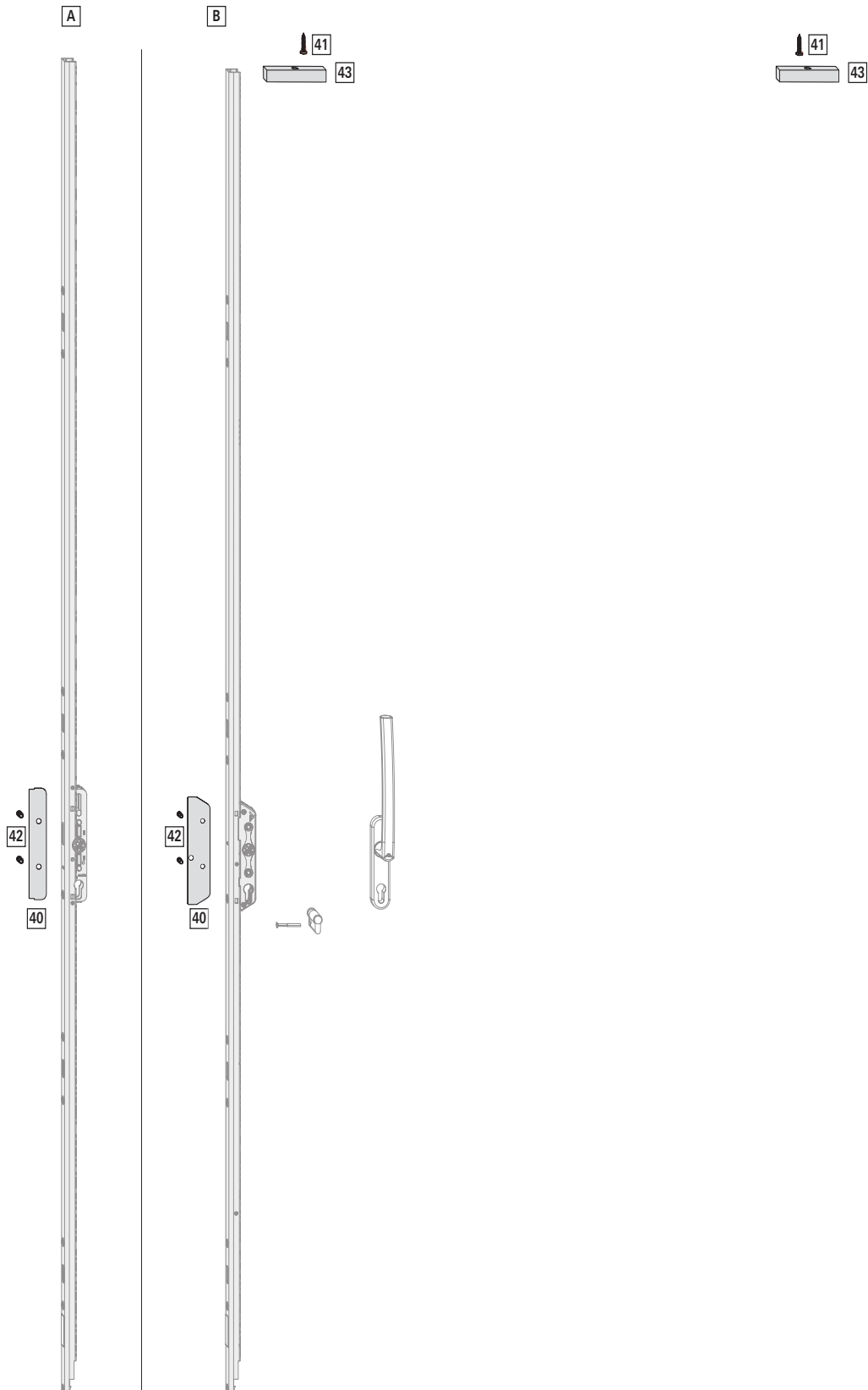
Fig. 4.11: imagen: esquema A; diseño a la izquierda; AIH 2400 mm; Slim [A] 200 kg y estándar [B] FG 300 / 400 kg; manilla con llave
