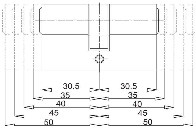
\* Coloque el eje del canal al centro de la figura. Aumente 1cm por lado para utilizar con manillas de ventana o puertas comunes. Aumente 1.5cm por lado para manillas de puerta elevable
