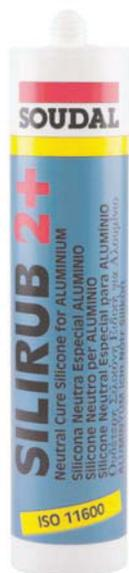
Sellador de silicon para alto desempeño, excelente resistencia a los rayos UV. Modulo medio, monocomponente y de curado neutro. Capacidad de movimiento  $\pm 40\%$  aplicable a temperatura de  $-60^{\circ}\text{C}$  a  $180^{\circ}\text{C}$ , secado  $< 5$  horas, curado total de 7-14 días
