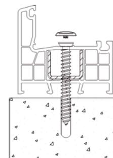
Tapon rigido para colocar dentro del perfil previa perforacion de 13mm en el marco.
